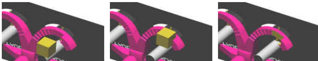
Soustraction booléenne utilisée pour créer la face d'un conducteur de lumière
