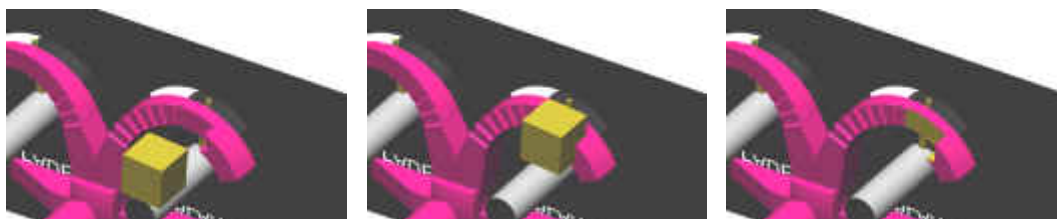
Boolesche Differenz, um eine Facette auf einem Lichtleiter zu erstellen
