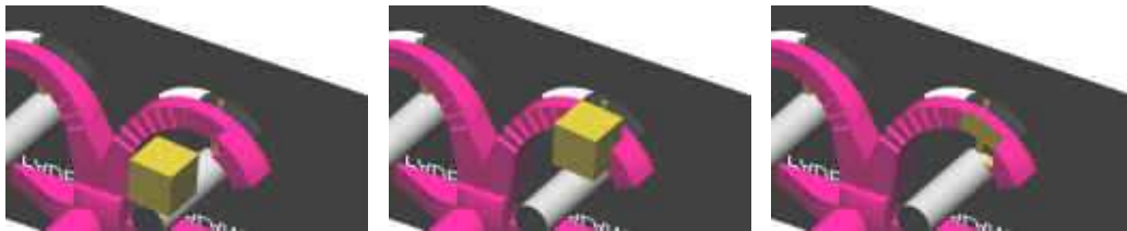
利用布林差集建立導光管上的階梯面
